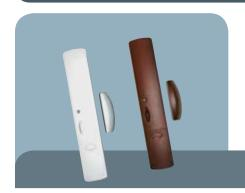
Installato su porte o finestre, protegge i locali da intrusi, anche quando si è in casa. La rilevazione avviene tramite contatto magnetico: la separazione del magnete dal trasmettitore attiva l'allarme. Oltre al contatto incorporato, permette il collegamento di altri sensori sul morsetto d'ingresso.
